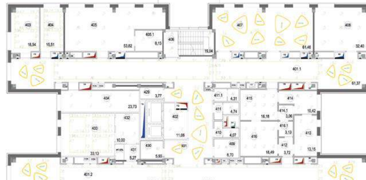
СХЕМА РАСПОЛОЖЕНИЯ ПОТОЛОЧНЫХ ПАНЕЛЕЙ НА ПЛАНЕ
