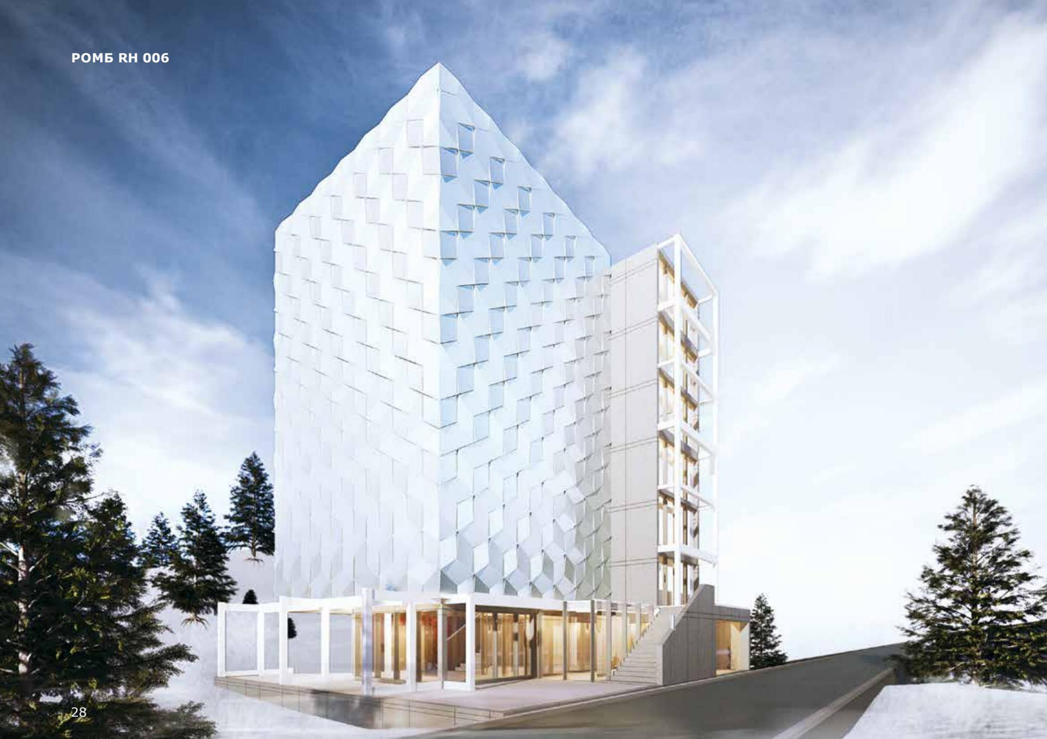
Данная форма панелей позволяет придать фасаду здания объем и оригинальный стиль. Фасадные панели PERFATEN ромбовидной формы широко применяются на различных зданиях и сооружениях, от небольших бизнес центров до крупных торгово-развлекательных. За счет своей формы такие кассеты создают сложный, многообразный и неповторимый визуальный эффект. Придать особую оригинальность зданию может комбинирование панелей с различными цветовыми оттенками, перфорацией или лазерной резкой.
